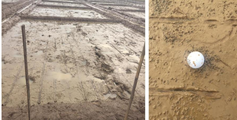
Gambar 15. Uji kekerasan permukaan tanah agar sesuai untuk sistem tanam benih langsung
